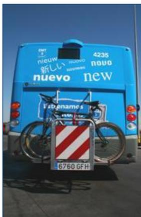
Fig 60. Soporte trasero para transporte de bicicletas en Madrid. Fuente: EMT
