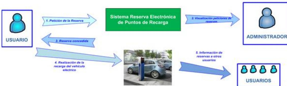
Fig 53. Esquema general de funcionamiento de una plataforma de reserva telemática de puntos de recarga
