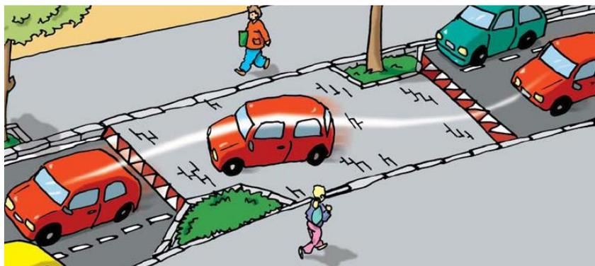
Fig 71. Desviación de trayectoria mediante arbolado: Fuente: RACC
